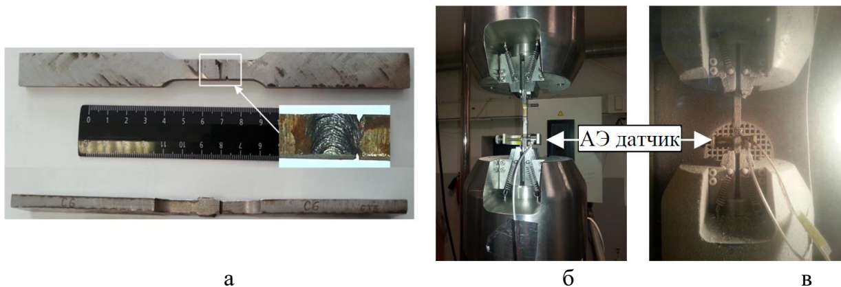
Рисунок 4.3 – Внешний вид образцов отдельно (а) и на испытательной машине перед циклическими испытаниями при температуре (б) – 296 К и (в) – 233 К (в окне рисунка (а) увеличенный фрагмент места ослабления до снятия слоя окалины и ржавчины)
