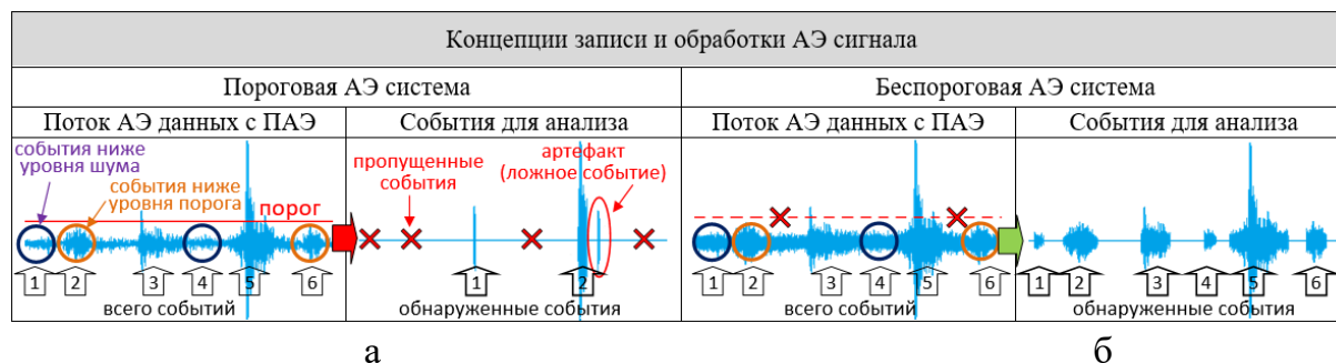
Рисунок 1.4 – Поясняющий рисунок к пороговой (а) и беспороговой (б) концепциям записи и обработки АЭ данных.
