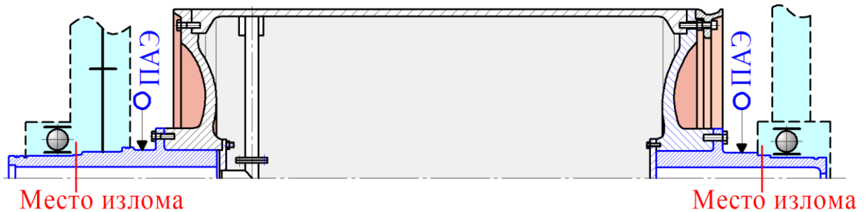
Рисунок 4.5 – Схема конструктивного исполнения сушильного цилиндра с указанием мест излома цапф и мест установки преобразователей АЭ.
